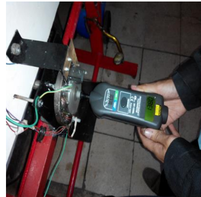
Gambar 20. Pengukuran kecepatan putaran motor dengan alat ukur tachometer
