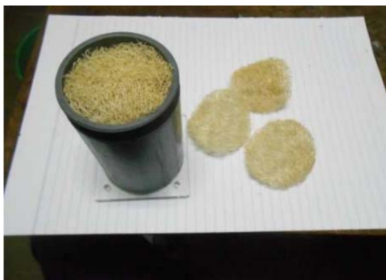
Gambar 6. Stack gambas kering yang telah disusun dalam pipa resonator PVC
