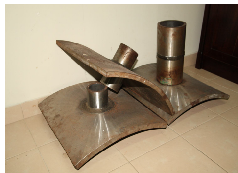
Gambar 8: Side Drilled Hole (kalibrasi UT)
